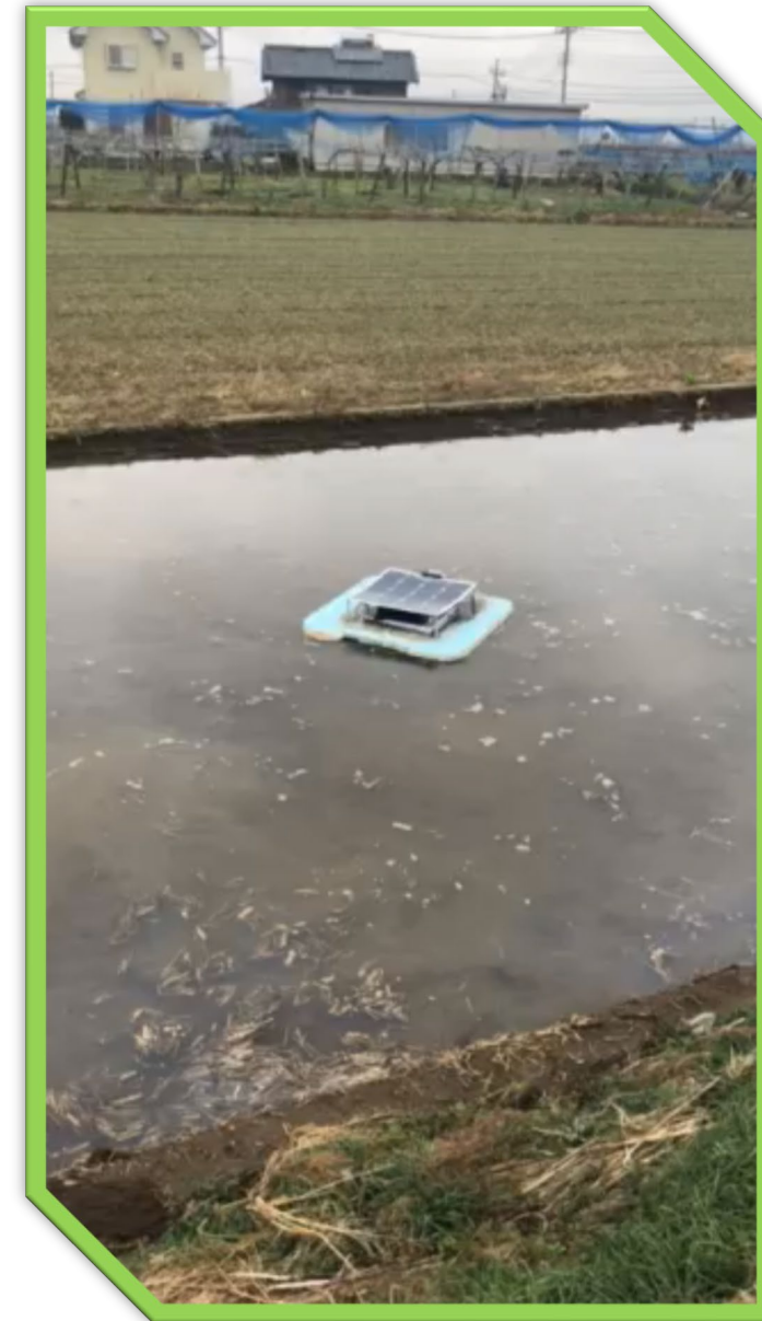
ソーラー発電アイガモロボット 試作、テスト
