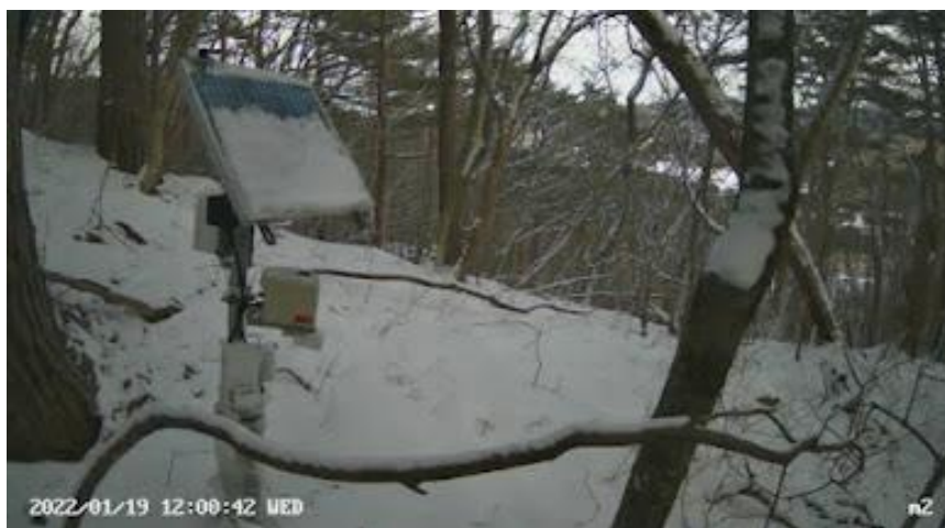
飯舘村山中に設置された LTE-WiFi カメラシステム (システムに繋がった別の WiFi カメラで撮影)
