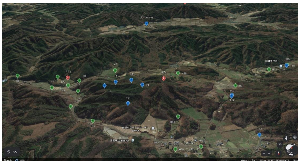
飯舘村山中に試験設置された LoRa の親機・中継器・センサーの配置図
