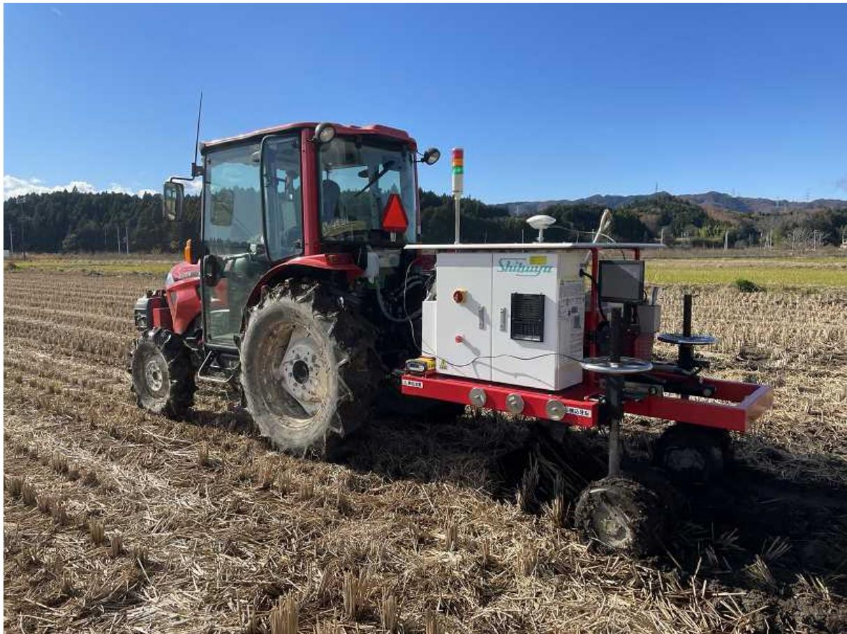
図1 本研究で使用したトラクタ搭載型の土壤分析システム.
