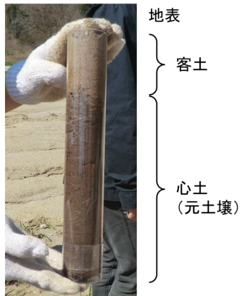
図2 2015年に除染後圃場から採取した土壤の外観（φ5 cm×30 cm）.
