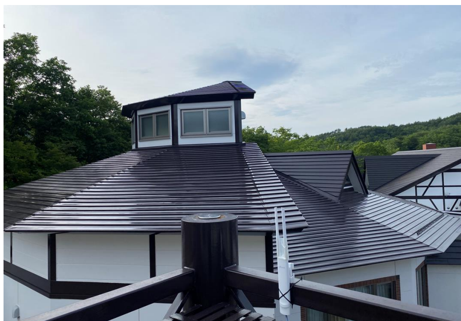
図2 きこり 2 階の多目的ルームのベランダの手すりに固定された AP (K0)
